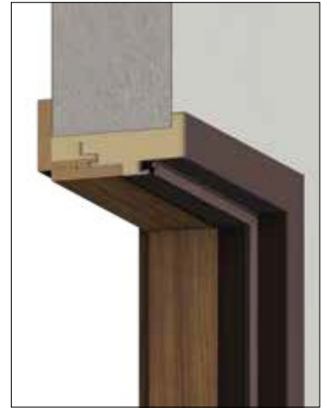
Wszystkie ościeznice przeznaczone są do montażu na gotowej podłodze.
